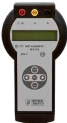
Принцип действия мегаомметров основан на измерении тока, проходящего через измеряемое сопротивление, приложении заданного постоянного испытательного напряжения.
