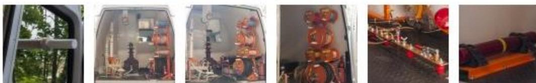
Стандартная базовая модель передвижной испытательной (подстанционной) электротехнической лаборатории СУРА выполнена на базе а/м ГАЗель Бизнес 27057, имеющий полный привод для труднодоступных мест. Оснащена высокой крышей для соблюдения безопасных расстояний при монтаже высоковольтного оборудования, мощным автономным отопителем для работы в условиях отрицательных температур.
