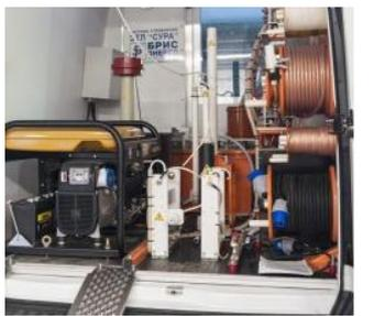
Передвижная кабельная электротехническая лаборатория "СУРА" для испытания и поиска мест повреждения кабельных линий, в том числе с изоляцией из сшитого полиэтилена базе ГАЗель NEXT предназначена для:
